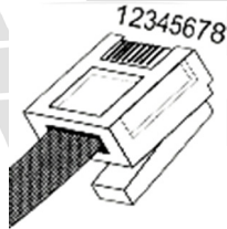
图 1 水晶头接线图
