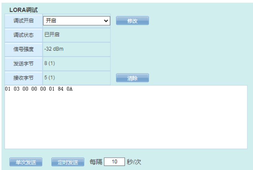
图 4.9 网关 Web 页面--无线 LORA 调试
