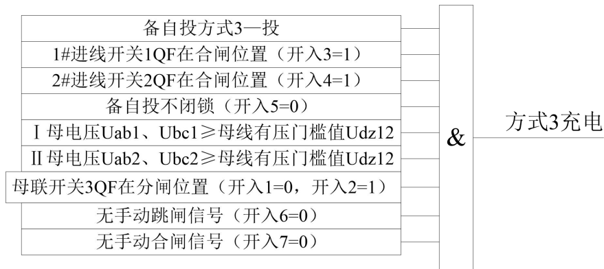
图 3-14: 备自投方式 3 的充电逻辑图
